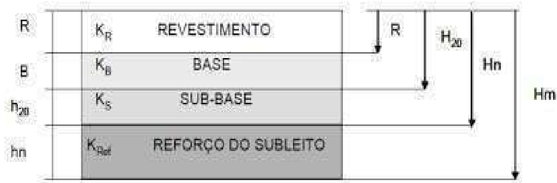
Figura 03. Dimensionamento de pavimento flexível
